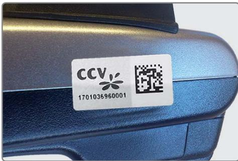
Ein beschädigtes Siegel weist wabenförmige Muster anstelle eines gleichmässigen Grautons auf, hat Risse oder Schnitte.
